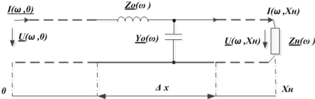
$$\begin{bmatrix} \underline{U}(\omega, 0) \\ \underline{I}(\omega, 0) \end{bmatrix} = \begin{bmatrix} \cos\left[\frac{\omega}{V_w} \cdot x\right] & j \cdot Z_w \cdot \sin\left[\frac{\omega}{V_w} \cdot x\right] \\ \frac{j}{Z_w} \cdot \sin\left[\frac{\omega}{V_w} \cdot x\right] & \cos\left[\frac{\omega}{V_w} \cdot x\right] \end{bmatrix} \cdot \begin{bmatrix} \underline{U}(\omega, x) \\ \underline{I}(\omega, x) \end{bmatrix}$$
