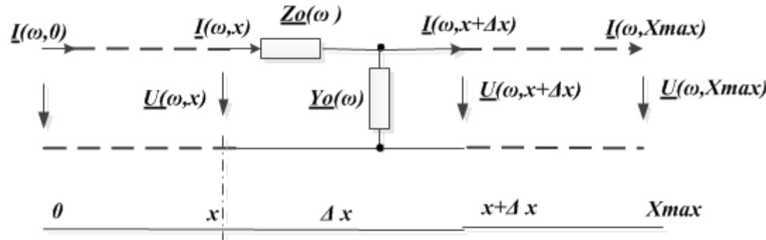
$$\begin{cases} \underline{U}(\omega, x) = \underline{U}(\omega, 0) \cdot ch[\underline{\gamma}_0(\omega) \cdot x] - Z_w \cdot \underline{I}(\omega, 0) \cdot sh[\underline{\gamma}_0(\omega) \cdot x]; \\ \underline{I}(\omega, x) = \underline{I}(\omega, 0) \cdot ch[\underline{\gamma}_0(\omega) \cdot x] - \frac{1}{Z_w} \cdot \underline{U}(\omega, 0) \cdot sh[\underline{\gamma}_0(\omega) \cdot x]; \end{cases}$$
