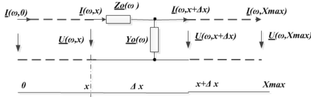
$$\begin{cases} \underline{U}(\omega, 0) = \underline{U}(\omega, x) \cdot ch[\underline{\gamma}_0(\omega) \cdot x] + \underline{Z}_w(\omega) \cdot \underline{I}(\omega, x) \cdot sh[\underline{\gamma}_0(\omega) \cdot x]; \\ \underline{I}(\omega, 0) = \frac{1}{\underline{Z}_w(\omega)} \cdot \underline{U}(\omega, x) \cdot sh[\underline{\gamma}_0(\omega) \cdot x] + \underline{I}(\omega, x) \cdot ch[\underline{\gamma}_0(\omega) \cdot x]; \end{cases}$$
