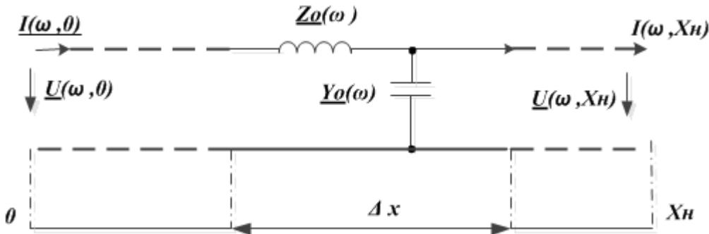
$$\begin{bmatrix} \underline{U}(\omega, 0) \\ \underline{I}(\omega, 0) \end{bmatrix} = \begin{bmatrix} \text{Cos}\left[\frac{\omega}{V_w} \cdot x\right] & j \cdot Z_w \cdot \text{Sin}\left[\frac{\omega}{V_w} \cdot x\right] \\ \frac{j}{Z_w} \cdot \text{Sin}\left[\frac{\omega}{V_w} \cdot x\right] & \text{Cos}\left[\frac{\omega}{V_w} \cdot x\right] \end{bmatrix} \cdot \begin{bmatrix} \underline{U}(\omega, x) \\ \underline{I}(\omega, x) \end{bmatrix}$$
