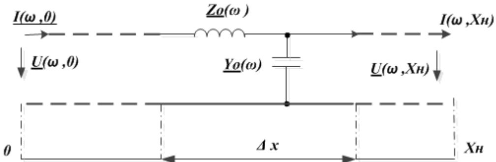
$$\begin{cases} \underline{U}(\omega, x) = \underline{U}(\omega, 0) \cdot ch[\underline{\gamma}_0(\omega) \cdot x] - Z_w \cdot \underline{I}(\omega, 0) \cdot sh[\underline{\gamma}_0(\omega) \cdot x]; \\ \underline{I}(\omega, x) = \underline{I}(\omega, 0) \cdot ch[\underline{\gamma}_0(\omega) \cdot x] - Z_w \cdot \underline{U}(\omega, 0) \cdot sh[\underline{\gamma}_0(\omega) \cdot x]; \end{cases}$$
