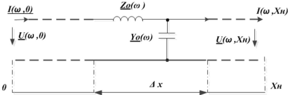
$$\begin{cases} \underline{U}(\omega, x) = \underline{U}(\omega, 0) \cdot ch[\underline{\gamma}_0(\omega) \cdot x] - Z_w \cdot \underline{I}(\omega, 0) \cdot sh[\underline{\gamma}_0(\omega) \cdot x]; \\ \underline{I}(\omega, x) = \underline{I}(\omega, 0) \cdot ch[\underline{\gamma}_0(\omega) \cdot x] - \frac{1}{Z_w} \cdot \underline{U}(\omega, 0) \cdot sh[\underline{\gamma}_0(\omega) \cdot x]; \end{cases}$$
