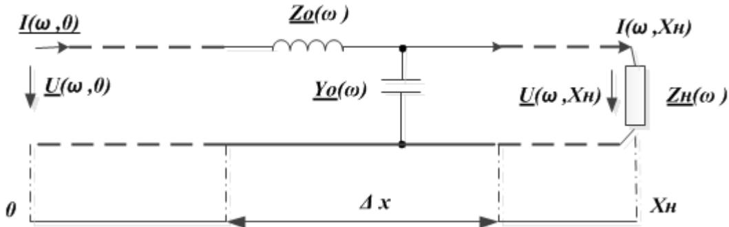
$$\underline{U}(\omega, 0) = \left[ \cos\left(\frac{\omega}{V_w} \cdot X_H\right) + j \cdot \frac{Z_w}{Z_H(\omega)} \cdot \sin\left(\frac{\omega}{V_w} \cdot X_H\right) \right] \cdot \underline{U}(\omega, X_H);$$
