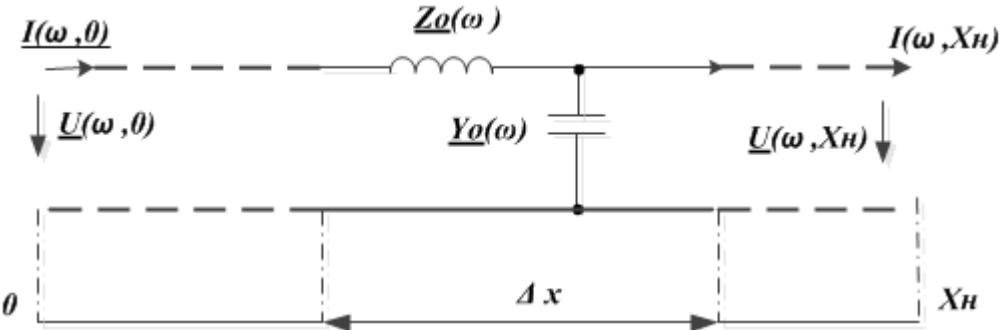
$$\begin{cases} \underline{U}(\omega, x) = \underline{U}(\omega, 0) \cdot \cos\left[\frac{\omega}{V_w} \cdot x\right] - j \cdot Z_w \cdot \underline{I}(\omega, 0) \cdot \sin\left[\frac{\omega}{V_w} \cdot x\right]; \\ \underline{I}(\omega, x) = \underline{I}(\omega, 0) \cdot \cos\left[\frac{\omega}{V_w} \cdot x\right] - \frac{j}{Z_w} \cdot \underline{U}(\omega, 0) \cdot \sin\left[\frac{\omega}{V_w} \cdot x\right]; \end{cases}$$
