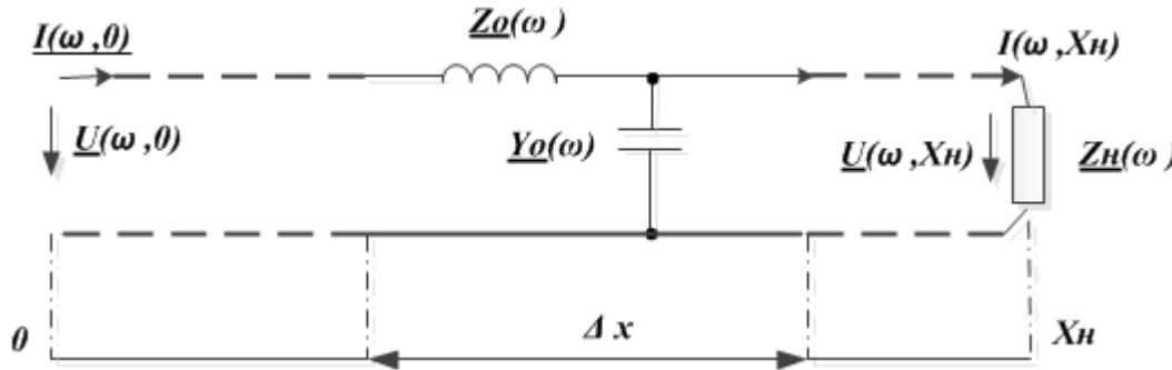
$$\underline{U}(\omega, X_H) = \left[ \cos\left(\frac{\omega}{V_w} \cdot X_H\right) - j \cdot \frac{Z_w}{Z_H(\omega)} \cdot \sin\left(\frac{\omega}{V_w} \cdot X_H\right) \right] \cdot \underline{U}(\omega, 0); \quad \frac{\omega}{V_w} \cdot X_H = \omega \cdot \tau_p$$
